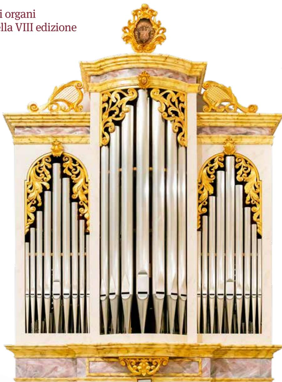
L'organo della cattedrale di Foggia, costruito dalla ditta Francesco Zanin di Codroipo (UD), è uno strumento a trasmissione meccanica con 22 registri disposti su due tastiere e pedaliera. Montato su una pedana mobile che può sollevarsi pneumaticamente in modo da potersi spostare agevolmente, è stato collocato a basamento nel transetto laterale. Lo strumento è stato donato alla Cattedrale di Foggia dalla Fondazione Monti Uniti ed è stato inaugurato nel luglio del 2015.
